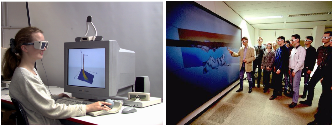
(a) Stereo-Monitor, LCD-Shutterbrille, Head-Tracking und SpaceBall: „Desktop-VR“
