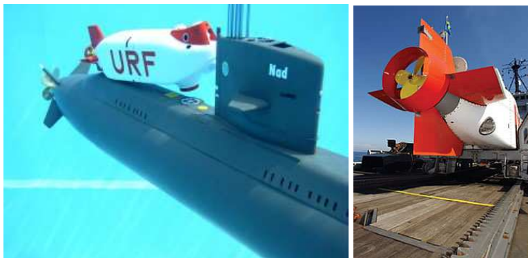
URFen som dockas på svensk ubåt (modell) 14 URFen med propellerdysa 15
