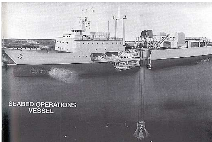
HMS Challenger (Källa: Welham, 1989, 117) är Royal Navys fartyg för bottenoperationer med en öppning i botten för utsläpp av bl.a. små farkoster av till synes samma typ som de som kan bäras av Oberonklassubåtar (se nedan).
