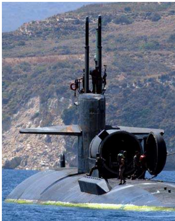
Amerikansk moderubåt USS Dallas med Dry Deck Shelter för minifarkoster (Mk VIII) 1
