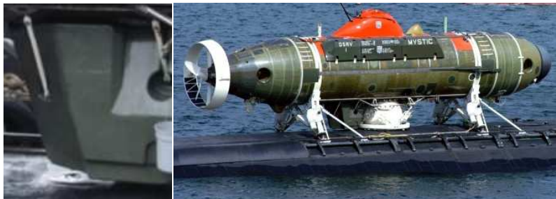
Uppförstoring av Mystics kapsel, som sägs dölja ett nedfällbart hjul. 75
