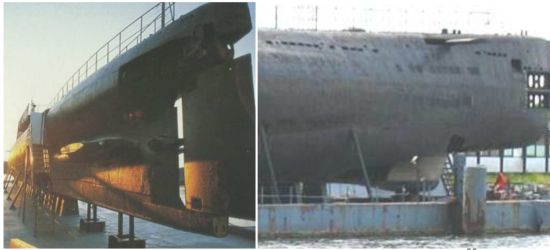
En utställd Projekt 613 Whiskey (U-359) i Nakskov (Danmark). 55 Whiskeyn är avsmalnande mot aktern, men den har ingen utanpåliggande köl. Under ubåtens för sticker en sonar ut, men det finns ingen köl bakom sonaren.
