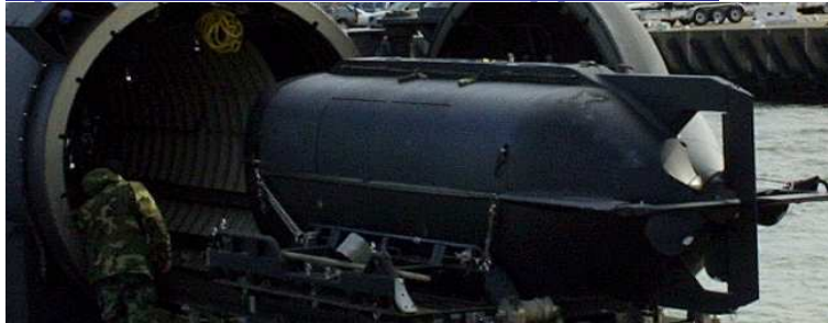
MK VIII som förs in i ett 'dry-dock shelter' (Norfolk, USA)
