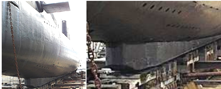
T.v. Oberonklassubåten HMAS Ovens (Australien) med främre delen av kölen samt ett djuproder högst upp. 47 Rodret är 2,2 meter långt. Kölens bredd i fören är ca 1/5 av rodret eller ca 45 cm, men kölen är sedan bredare. Skrovets bredd är 8,1 meter. T.h. detalj av kölen.
