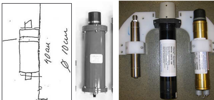
T.v: dykarnas teckning av föremålet nr. 1 utanför Mälsten. Teckningen visar ett termosliknande metallföremål som var monterat på en betongplatta. I mitten ses en transponder från TrackLink (se nästa sida). T.h: transpondrar från bl.a. Sonardyne som används av en amerikansk obemannade minifarkost. De senare opererar i frekvensområdet 19-36 KHz och 35-55 KHz. 102 Ett flertal transpondrar opererar i området 20-30 KHz. 103
