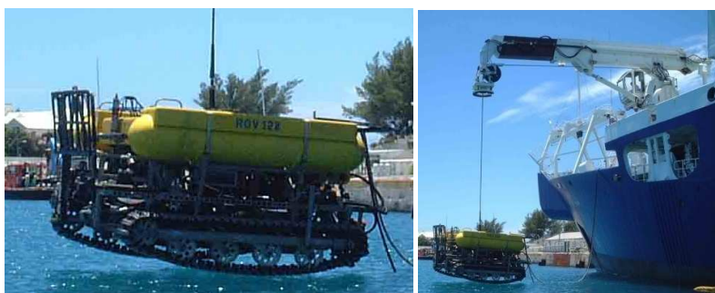
Den fjärrstyrda minifarkosten Rov 128 som användes för lägga ut kabel från kabelutläggningsfartyget Sir Eric Sharp . 19 Bandaggregat var nödvändigt för att den skulle kunna arbeta på botten.
