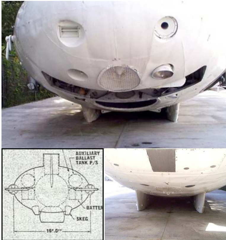
Deep Quest är 4,88 meter (16 feet) bred, vilket ger närmare 30 cm breda medar och 1,6 meter mellan medarna. Bilderna är från Naval Undersea Museum, Washington State. 77
