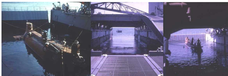
T.v. akterporten stängs. Djuphavsfarkosten Aluminaut på vattenfyllt 'well-däck' på USS Plymouth Rock . I mitten och t.h. utsikt över 'well-däck'. 117
