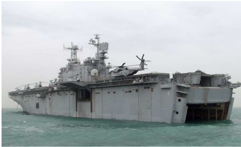
LHA-1 Tarawa som kan transportera små ytfarkoster och ubåtar som tas in genom akterporten, in på ett vattenfyllt 'well-däck' 99
