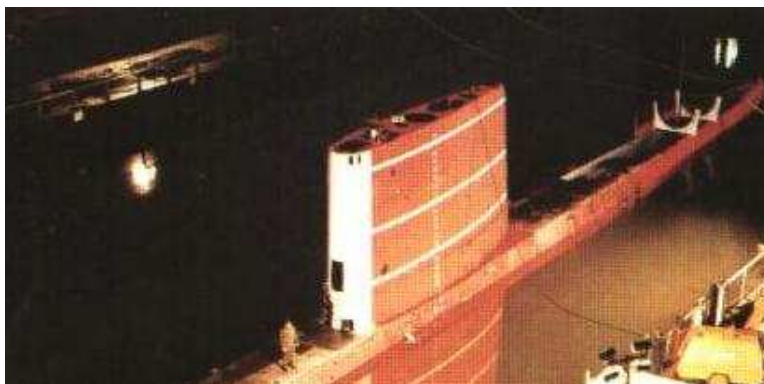
HMS Porpoise , som opererade i Östersjön, ska ha tagits ur aktiv tjänst efter 1982. Här ses Porpoise anpassad för specialoperationer med en vit tornfront och ett stativ i aktern för en minifarkost (DSRV). 111
