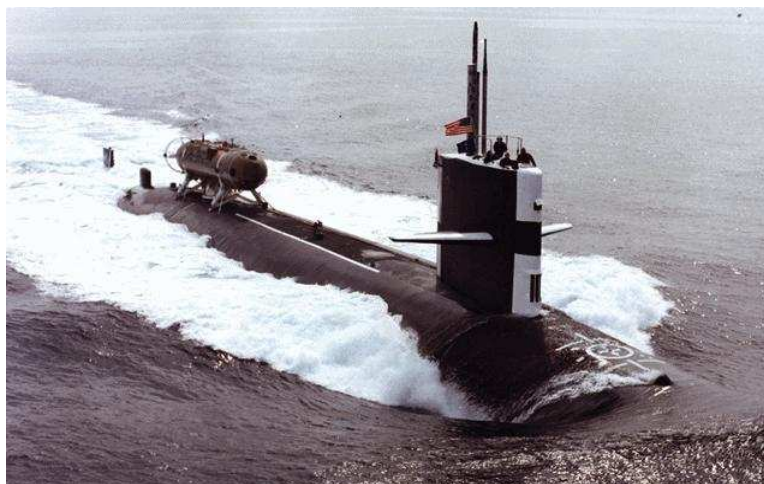
US Navys minifarkost DSRV Avalon på Cavalla , 149 som 1982 förseddes med Dry Deck Shelter för att bära dykarfarkoster som Mk VIII.
