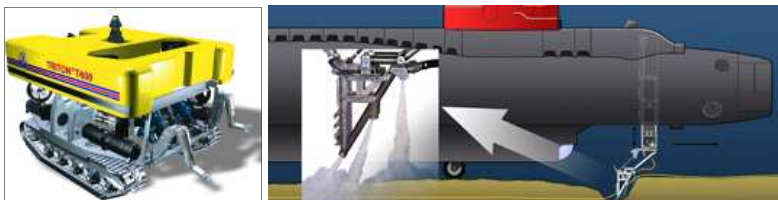
T.v. en fjärrstyrd bandgående farkost för bottenarbeten. 22 T.h. reklam för kabelutläggningsverktyg använt av NR-1 (om hjul se nedan). 23
