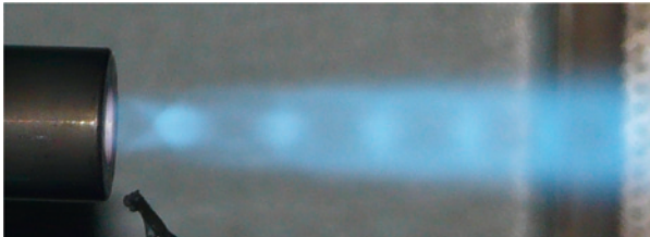
Abb. 4.46: Freistrahlgemietrie des Brenners aus Abbildung 4.41 bei hoher Prozessleistung
