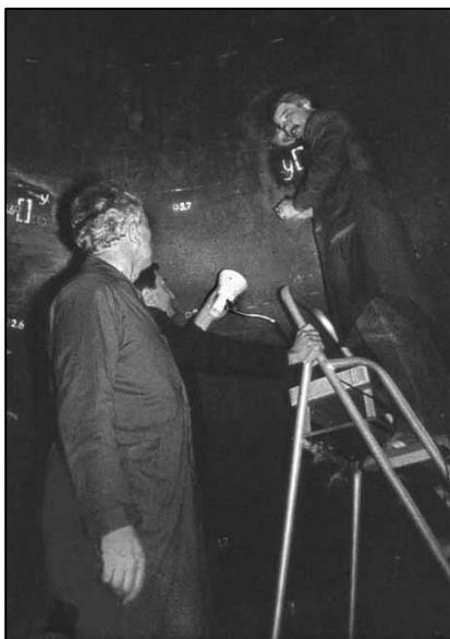
**Рис. 55.** Работы «под колоколом»: зачистка поверхности, наклейка тензометрических и АЭ-датчиков
