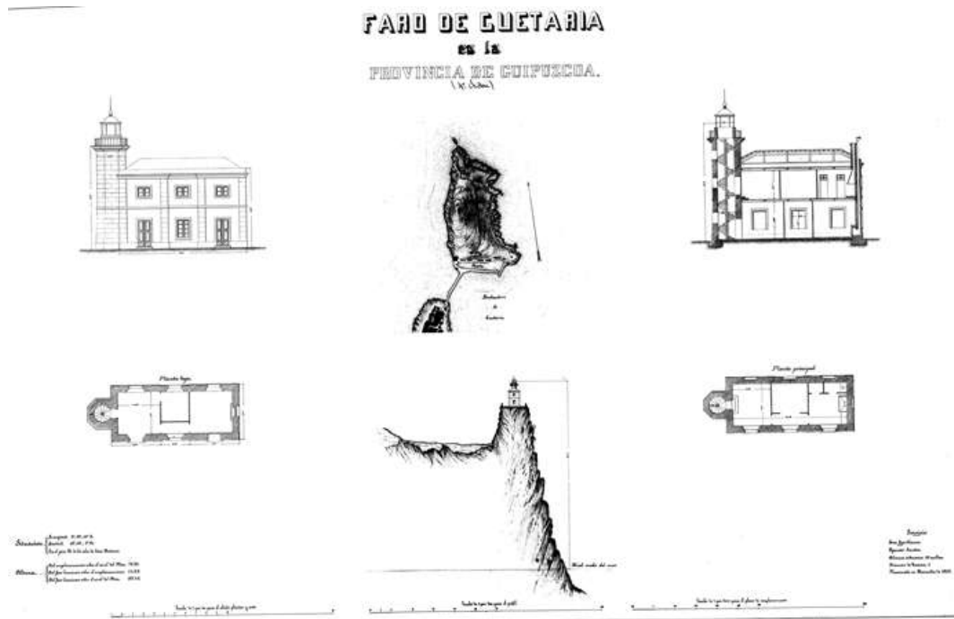
Plantas, alzado, sección por la torre, secciones de la torre y terreno y ubicación orográfica.
