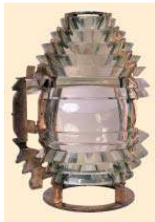
Figura 5. Óptica dióptrica catadióptrica para faro de 5º Orden (Fuente Puertos del Estado).
