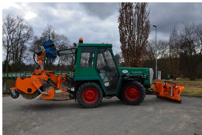
Traktor na celoroční údržbu, vpředu radlice na odmetání sněhu se záběrem 140 cm, vzadu zametací souprava. K traktoru lze připevnit i kropič, sypač, mulčovač na trávu nebo vlečku.
