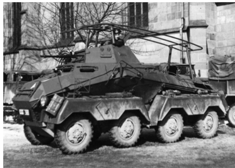
Sd. Kfz. 232 Acht Rad. Obrněný radiovůz; rychlost úctyhodných 90km/hod; osádka 4 muži, výzbroj – kulomet MG 13 ráže 7,92 mm; kanon KwK 30, ráže 20mm; rámová anténa, teprve pozdější typy měly anténu prutovou na pravé straně vozu. Před chrámem sv. Vavřince, březen 1939. (RMVM).
