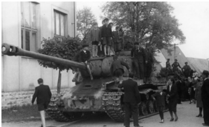
Těžký tank IS – 2. Tank vyvinutý v roce 1943 k ničení těžkých německých tanků na velkou vzdálenost. Posádka 4 muži. Hlavní zbraň kanon D25T ráže 122 mm; dále tři kulometry DT ráže 7,62mm a jeden kulomet DŠK ráže 12,7mm. Husova ulice, před orlovnou. Květen 1945. (RMVM).
