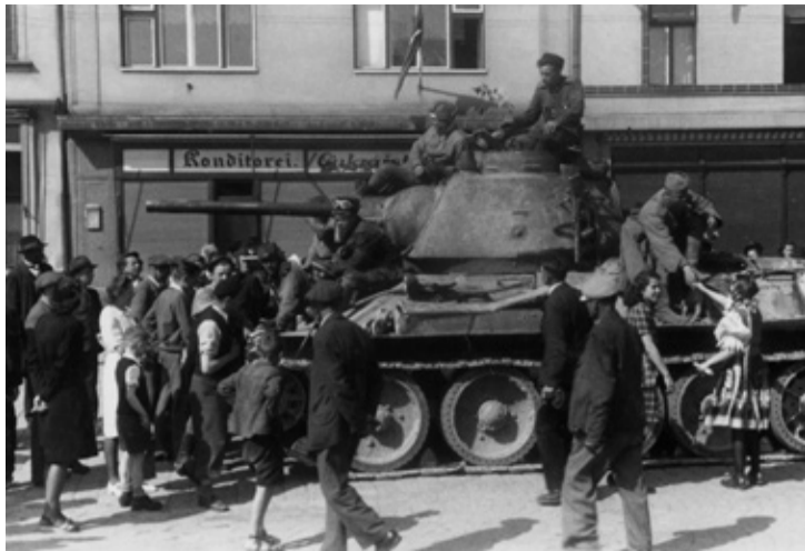
Legendární tank střední třídy T34. Tank vyráběný od roku 1940. Posádku tvořili čtyři muži. Hlavní zbraň kanon ZiS-S-53 ráže 85 mm, dva kulometry DT ráže 7,62 mm. Vysokomýtské náměstí. Pravděpodobně 9. květen 1945. (RMVM).
