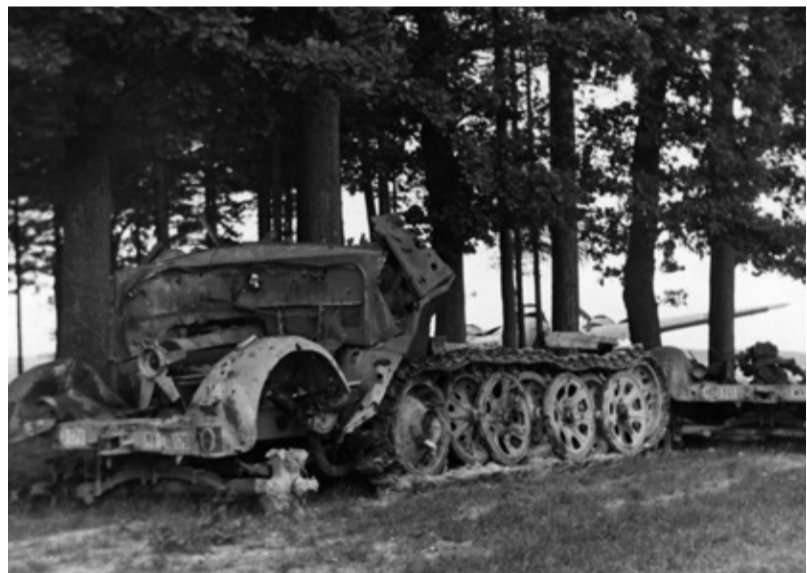
Sd. Kfz. 7. Samohybné protiletadlové dělo Sd.Kfz 7, tovární označení KMm 11 (Krauss Maffei). Vozidlo bylo vyzbrojeno čtyřhlavňovým kompletem Flakvierling 38, tedy protiletadlovým čtyřčtetem ráže 20 mm. Podle označení na vozidle víme, že pocházelo od 1. Ski-Jäger-Division (1. lyžařské divize). Letiště Harta. Květen 1945. (RMVM).
