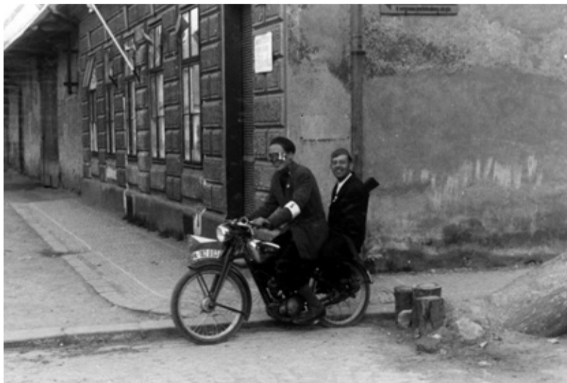
“Revoluční” motocykl Jawa Robot – motokolo s motorem 98 ccm. Za normálních okolností jednomístný stroj. Bojovník, který sedí vzadu, tedy nemá kam dát nohy – prostě to nemá druhé stupečky. Nároží ulice Komenského a Generála Závady. Květen 1945. (RMVM).
