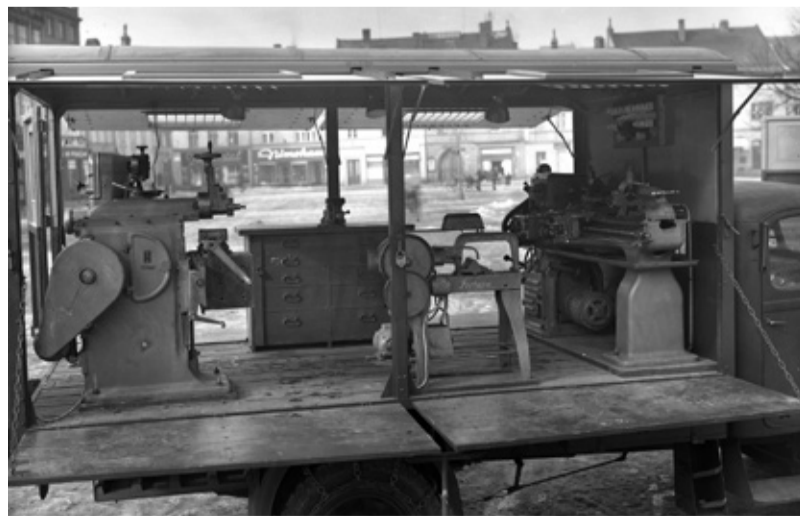
Pohled do dílny umístěné na voze Škoda. V případě potřeby bylo možné zařízení i vrchní nástavbu demontovat a z vozidla tak vytvořit univerzální valník. Foto: Jan Popelka, (RMVM).
