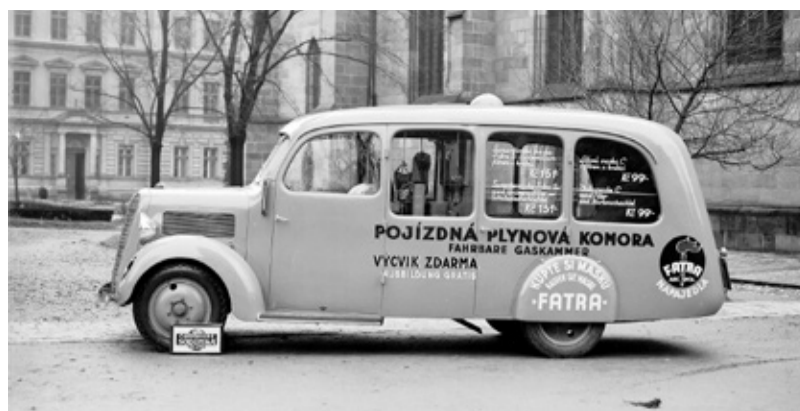
V letech 1936 až 1937 vznikla speciální karoserie na podvozku Walter PN na předvádění a zkoušení plynových masek pro akciovou Společnost Fatra Napajedla. Ne příliš vhodně zvolený propagační název „Pojízdná plynová komora“ byl v období po roce 1948 mylně interpretován tak, že během druhé světové války vyráběla firma Sodomka pro Třetí říši pojízdné plynové komory s využitím pro tzv. konečné řešení židovské otázky. Foto: Jan Popelka, (RMVM).
