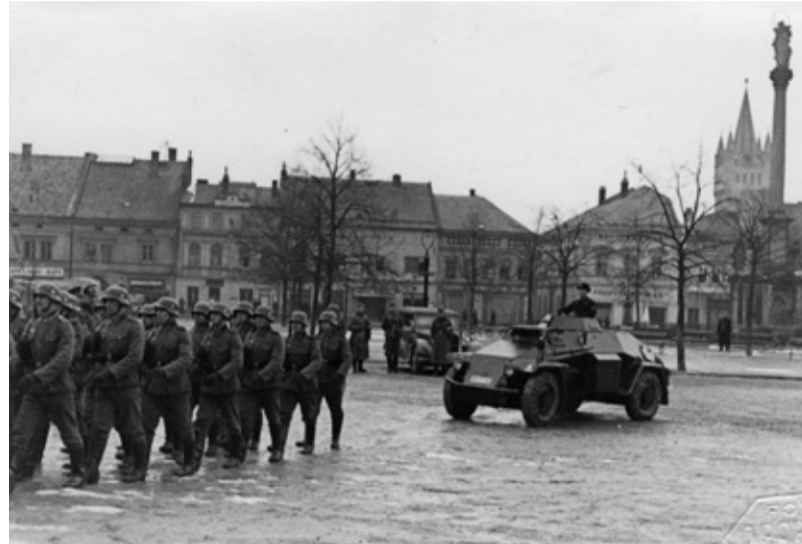
Sd. Kfz. 221. Lehký obrněný automobil s motorem Horch 3,5l; max. rychlost 80 km/h, osádka 2 muži, výzbroj kulomet MG 34, ráže 7,92mm. Vysokomyštské náměstí, březen 1939. (RMVM).
