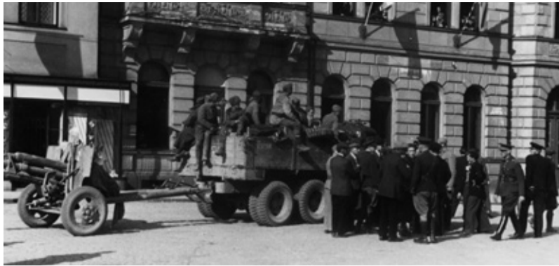
Nákladní automobil Studebaker US-6 s kanonem ZiS-3. Sovětský 76,2 mm divizní kanon vz. 42 (ZiS-3) bylo jedno z nejlepších děl druhé světové války. Kanon byl u sovětských vojáků značně oblíben, byl velmi výkonný, pohyblivý, odolný a díky malé hmotnosti, spolu se zaměřovačem pro přímou střelbu a vhodnou municí se osvědčil i v protitankovém boji, kde vystačil na všechny německé lehké i střední tanky. Vysokomýtské náměstí. Květen 1945. (RMVM).
