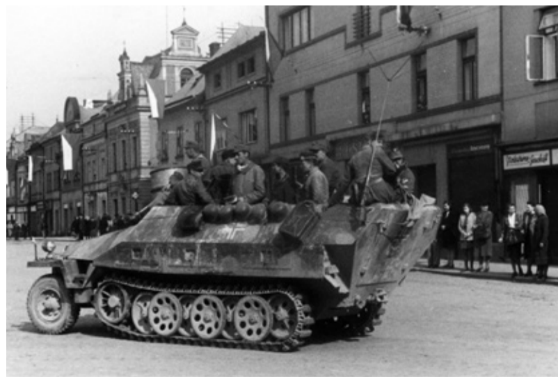
SdKfz 251 byl základní obrněný transportér německé armády vyvinutý ve firmě Hanomag jako typ HKL6p. Vážil 9 tun a uvezl 10 pěšáků, kulometčíka, velitele a řidiče. Byl standardně vyzbrojen dvěma kulomety MG 34 nebo 42. Začal se používat v roce 1939 a byl nasazen hlavně u tankových divízi. Tento stroj je od 16. Panzer-Division (16. tankové divize). Po válce jich zůstalo velké množství na našem území a používala je i československá armáda. U nás se pro něj vžil lidový název „haki“. Vysokomyštské náměstí, pravděpodobně 9. květen 1945. (RMVM).
