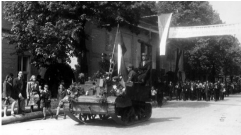
Universal Carrier. Britský obrněný transportér vyráběný od roku 1940, motor Ford V-8, max. rychlost 53 km/h; výzbroj standardně kulomet Bren ráže 7,7 mm nebo protitanková puška Boys ráže 13,9mm, ale objevovaly se i jiné zbraně včetně kořistných německých MG42. Revoluční gardy ho pravděpodobně získaly od československého armádního sboru ve Velké Británii. Pražská třída. Květen 1945. (RMVM).
