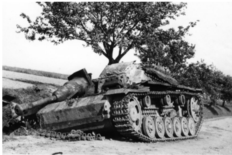
Sturmgeschütz III. Jeden z nejúspěšnějších německých bojových strojů - samohybné dělo. V průběhu ruského tažení se jeho původní funkce samohybného děla k ničení bunkrů, kulometných hnízd atd. změnila na funkci protitankové zbraně a přesnější označení bylo bezvěžový tank. Neurčené místo, snad cesta z Hrušové k cihelně Na Krétě. Květen 1945. (RMVM).
