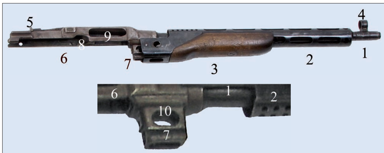
5. ábra. A 7,92 mm-es rohampuska csövének és csőnyúlványának részei: 1. cső, 2. csőköpeny, 3. mellső ágy, 4. célgömb a célgömbvédővel, 5. irányzék, 6. tokfedél, 7. tokfedélnyúlvány (cső és a tok egyesítésére), 8. kivágás (a felhúzófogantyú részére), 9. kivetőnyílás, 10. áttörtet (a csőrögzítő befogadására és a cső hátrasiklásának biztosítására)
