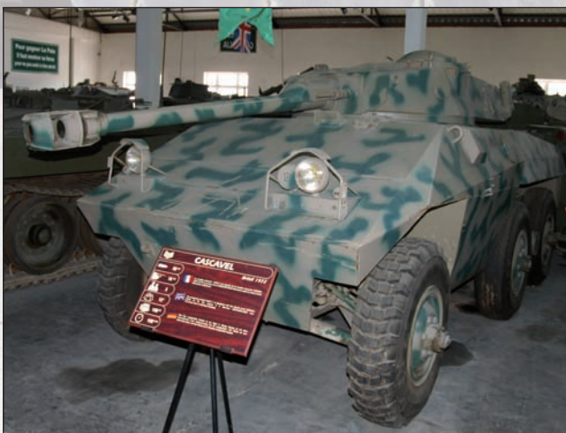
15. ábra. A múzeum egyik különlegessége a brazil gyártmányú Cascavel keres felderítő jármű. Lövegével veszélyes ellenfele lehet egy régebbi típusú közepes harckocsinak is, de védettsége csekély, tűzerejéhez és mozgékonyágához viszonyítva
