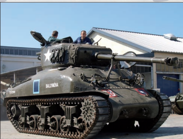
11. ábra. Az M 4A1 Sherman 76 mm-es hosszúcsövű lövege sem biztosított kellő átütőerőt a német Panther, Tiger és Königtiger harckocsik ellen
