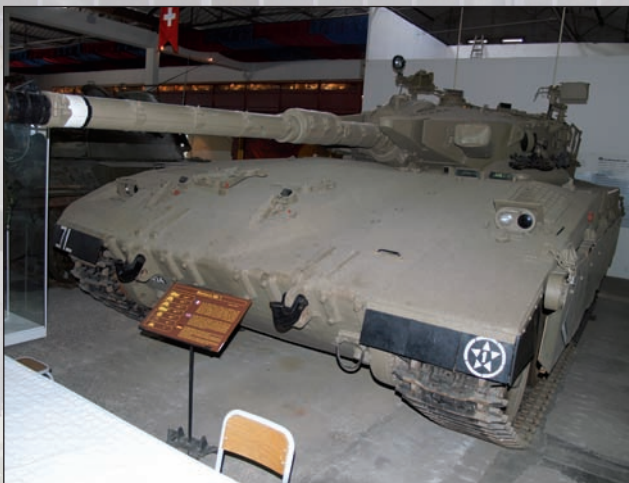
14. ábra. A Merkava I. az izraeli harckocsigyártás kiemelkedő alap harckocsija. A különleges felépítés elsősorban a kezelőszemélyzet védelmét segíti elő
