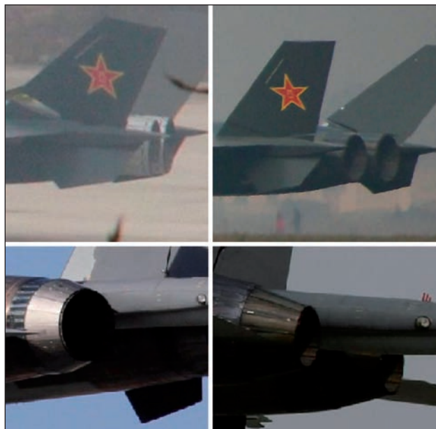
6. ábra. A két gép kétféle hajtóművel. Baloldalon a WS-10A gázturbinával szerelt (a J-11B hajtóműve), jobboldalon az AL-31F gázturbinával szerelt (a J-11A hajtóműve) példány
