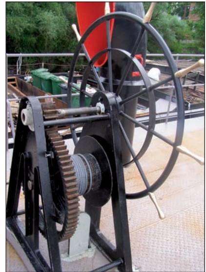
12. ábra. A kormánykerék a drótkötél vezetékekkel. Mögötte az egyik szellőző kürtő
