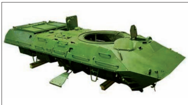
6. ábra. Az egyik utolsó változat páncélteste (forrás: http://www.zavodkorpusev.ru )
