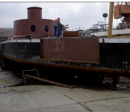
3. ábra. A bordabeugrást követő új lemezek
