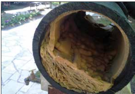
Berekfürdő: a 800 m mélyről feltörő 55 fokos termálvízből kiváló magas karbonát tartalmú vízkő gyorsan eltömi a csöveket (2015. május)
