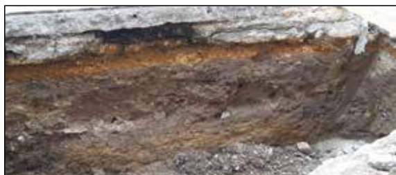
Budapest: A városi talajokat a WRB nemzetközi osztályozás önálló típusként kezeli. Ez egy városi feltöltött rétegsor, ún. Urbic Mollic Technosol (Villányi út (XI. ker.) elején) (2018. november)
