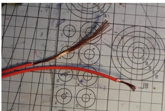
Obrázek 11 konce vodiče bez izolace
