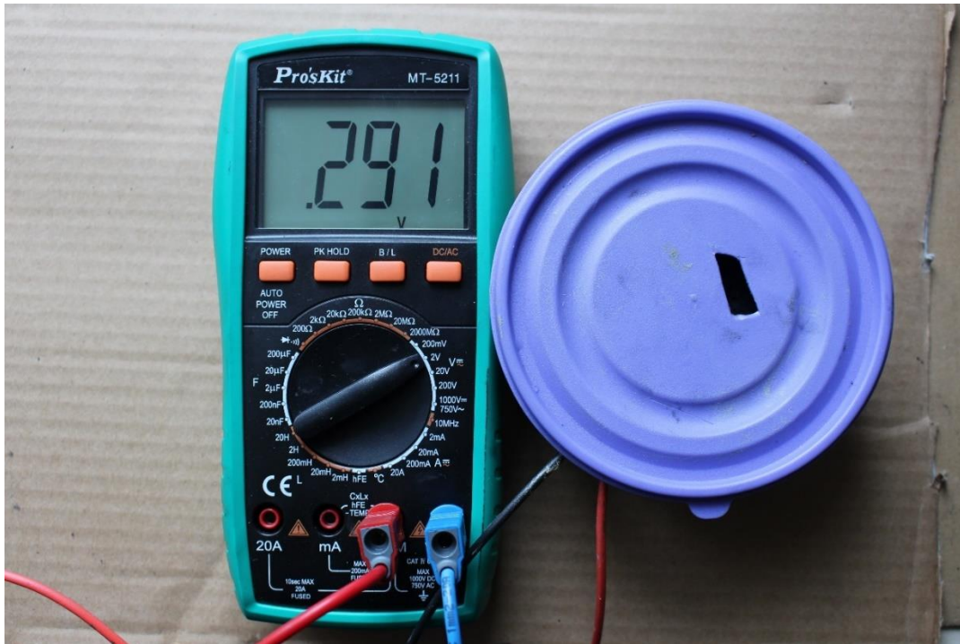
Obrázek 33 hotový článek připojený na voltmetr
