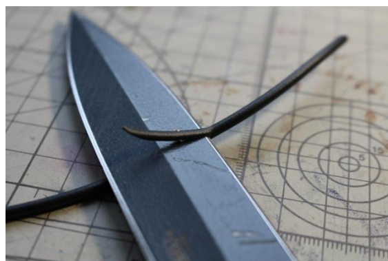
Obrázek 9 užití nože místo el. kleští
