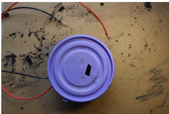
Obrázek 32 kompletní, uzavřený článek
