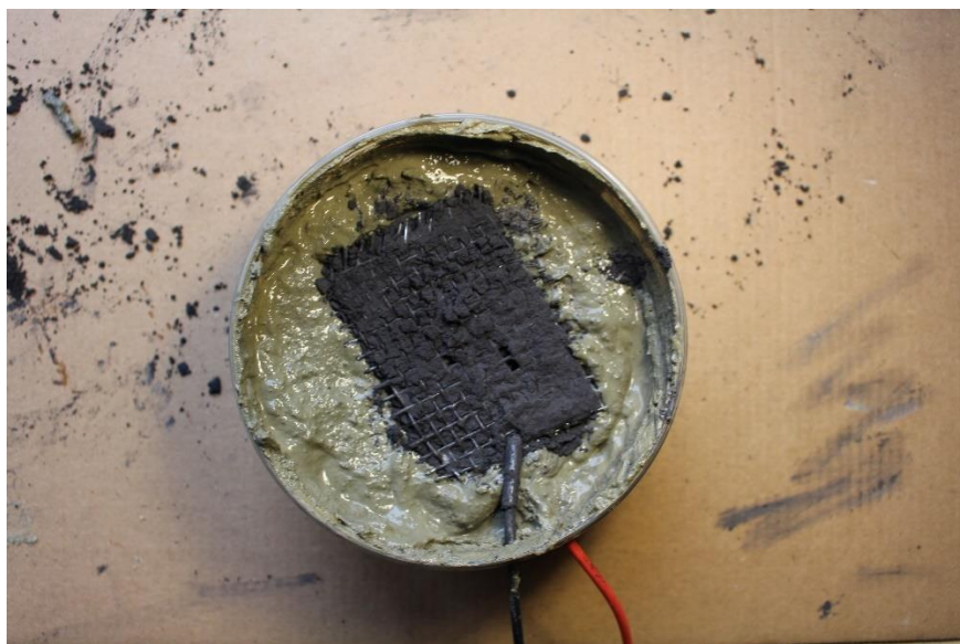
Obrázek 30 katoda na povrchu článku
