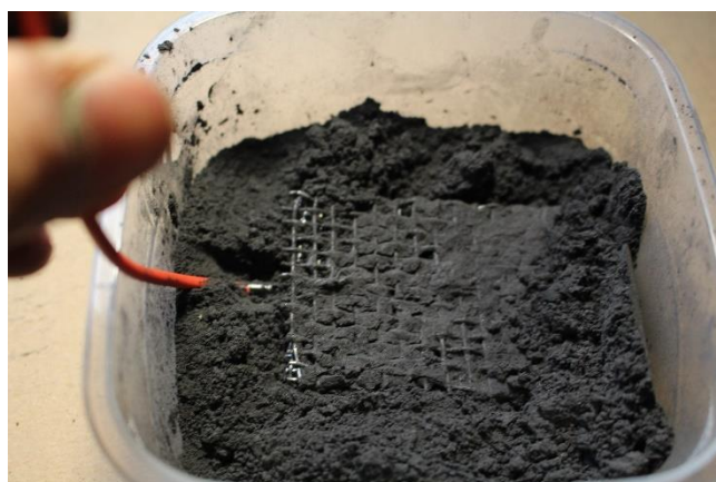
Obrázek 24 elektroda v grafitu - obě strany
