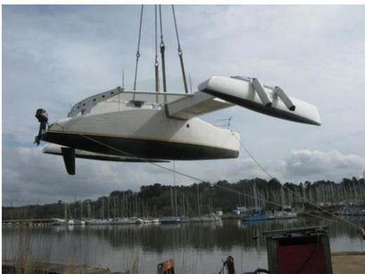
*du winch central et déplacement de la barre sous la barre d'écoute, reprise du fond de cockpit en nid d'abeille, reconstruction du support moteur, démontage du circuit électrique. Peinture généralisée coque et flotteur, primaire époxy puis laque polyuréthane bi composant, antidérapant sur le pont et partie centrale de flotteurs. Installation d'un capelage de code 5 sur le mât, changement d'étai, de stockeur de genaker, puis peinture... Ouf ! Christophe Beurois pour l'équipe de Trinitrine*
