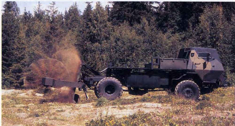
SISU pansret minerydningsplejl Foto: SISU Defence
