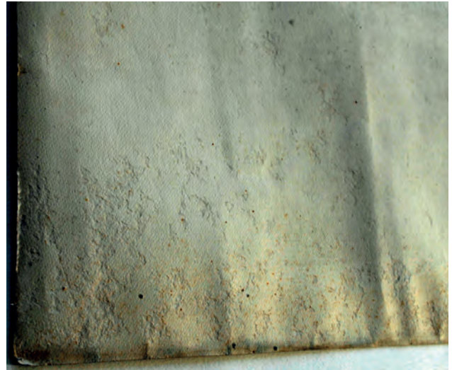
(Figura 6) Pyto. de Edificio para Junta Municipal y Juzgados de Melilla. Degradación del papel por microorganismos, reverso de la obra antes de restaurar.
