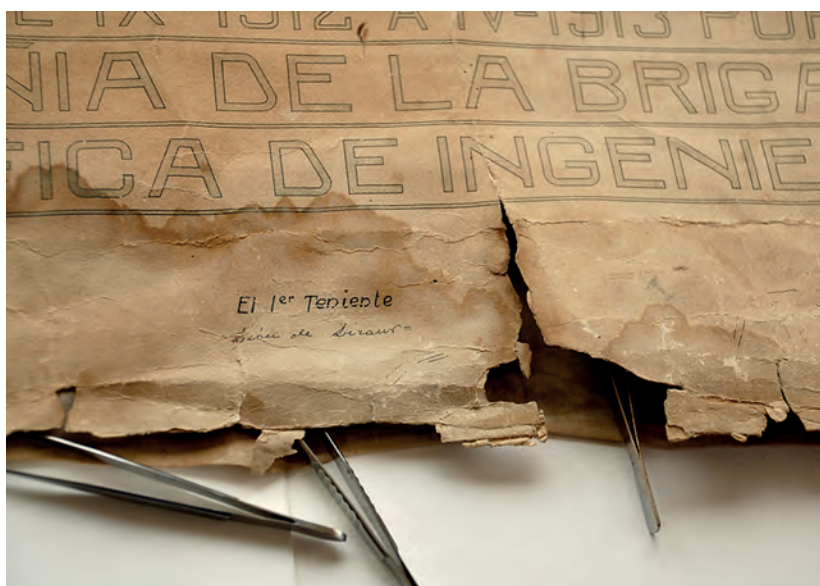
(Figura 10) Plano de Melilla dibujo tinta china y lápices de color de 1912-1913, medidas 1,17 x 1,20, Ingenieros topográficos. Degradación del papel por humedad, ocasionando debilidad y desgarros.
