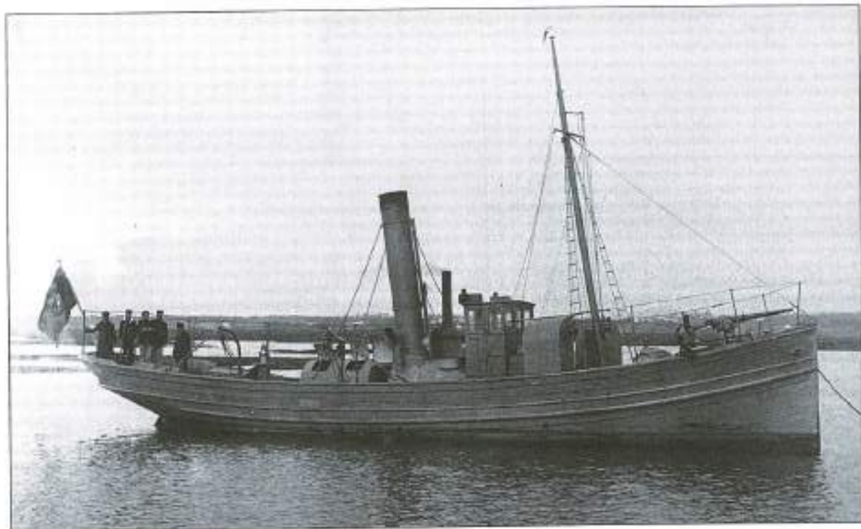
O patrulha-suslítor TENENTE ROBY artilhado com uma peça Hotchkiss de 47 mm, montada em caça
