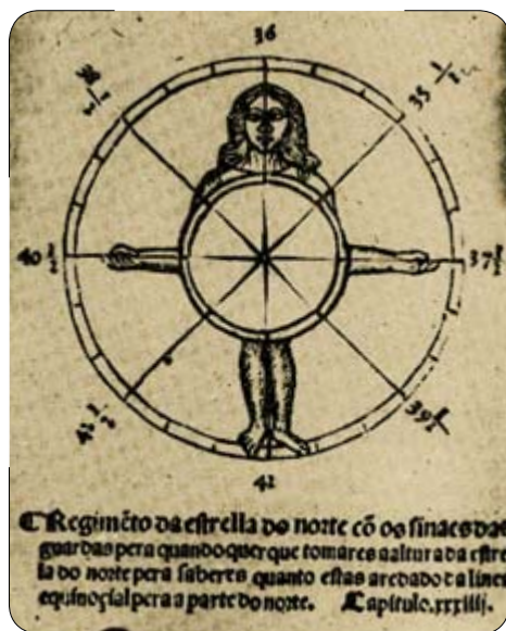
O “regimento da Estrela do Norte”, que permitia a determinação da latitude pela Estrela Polar (Gravura da edição de 1518 do Reportório dos Tempos de Valentim Fernandes)
