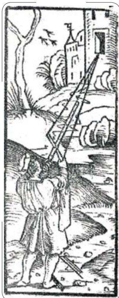
Medição da altura e da largura da janela de uma torre com a balestilha
