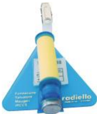
Figuur 9: Radiello passieve voor sampler met mini-thermometer temperatuur en relatieve vochtigheid
