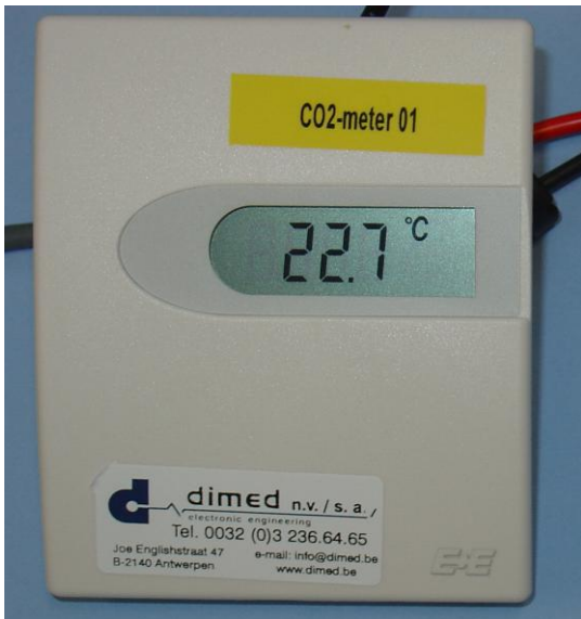
Figuur 11: E+E Elektronik toestel voor het meten van CO 2 , temperatuur en relatieve vochtigheid (zonder weersbestendige behuizing)
