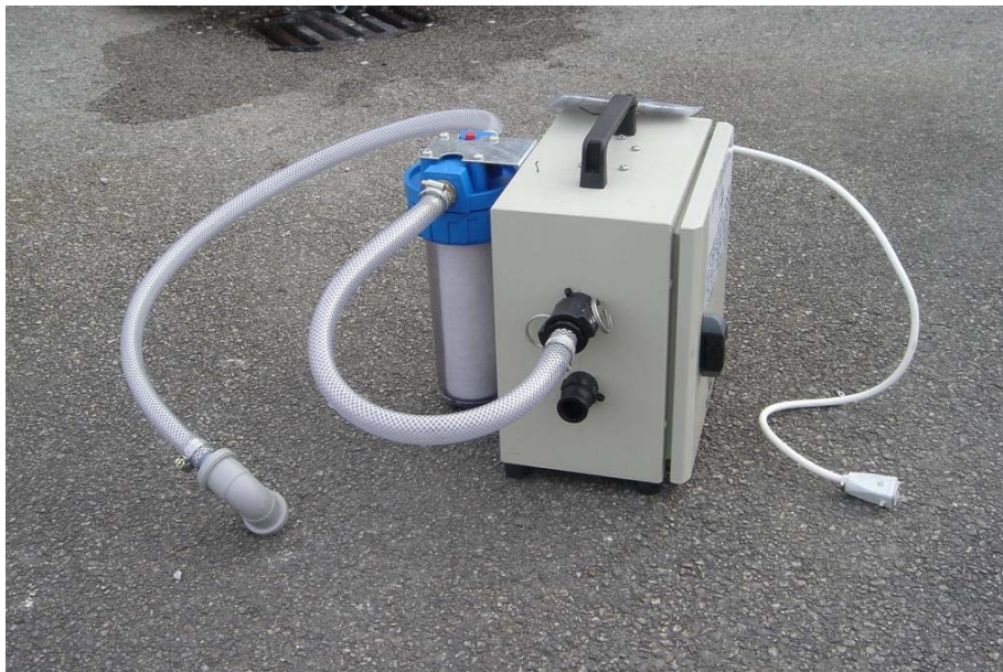
Obrázek 8.1: Zařízení na filtraci vody vytékající z dekontaminační jednotky. Obrázek poskytl HSE Spojeného království.
