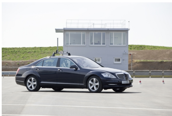
(a) Fahrzeug ausgerüstet mit einem Fahrroboter und Inertialmessensorik mit DGPS
