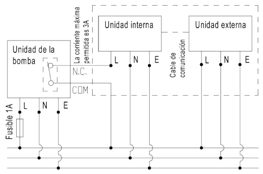
1. Por favor revise el diagrama de cableado del aire acondicionado dentro de las líneas interrumpidas.
