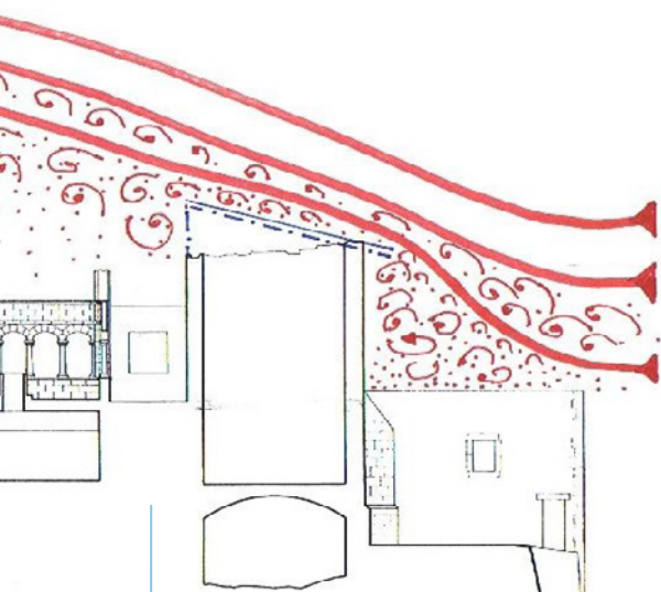
Simulació de la trajectòria del flux del vent a la teulada de l'ala sud. Disseny: A. Pallejà i R. Valls. Foto: Consol Marcó
