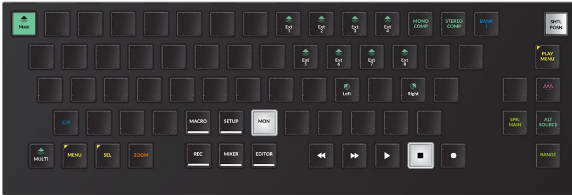
ジョグホイールの近くにフェーズ、メイン/ニアスピーカーの選択、Altソースキーを備えた代替Monitorツールセットを用意
