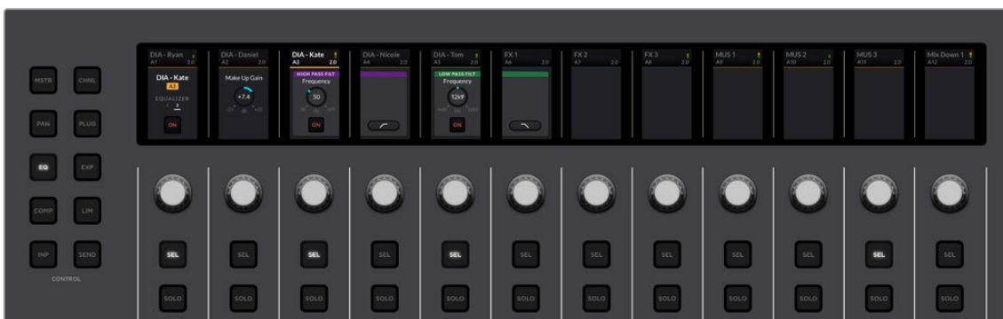
EQコントロールセット ページ2 (バンド1と6のフィルター用コントロール付き)
