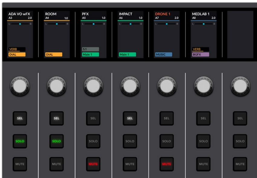
フェーダーチャンネル・ストリップにミュート、ソロ、セレクトの各ボタンがあるDesktop Console
