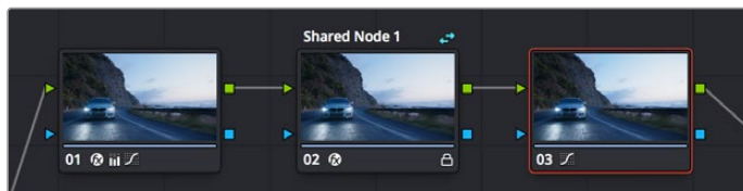
非共有ノード（左）と共有ノード（中央）を持つグレード。バッジはロックされた共有ノードを示す。
