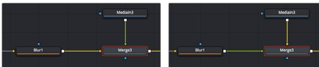
ノード入力の入れ替え前 (左)、ノード入力の入れ替え後。接続ラインは移動しないが色が変わる (右)
