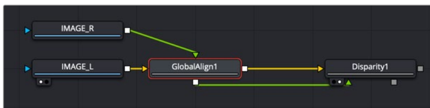
左右の目のズレを手動で補正するためのGlobal Alignノード
