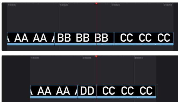
再生ヘッドのクリップ全体 (BB) と後続クリップ (DD) を差し替えるリップル上書き
