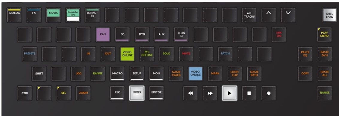
ジョグホイールの近くにMix Onのアンラッチ、Copy/Pasteのラッチ、Copy/Pasteキーがある代替Mixerツールセット
