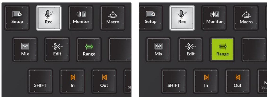
「Range」キーが解除された状態、「Range」キーがラッチされた状態
