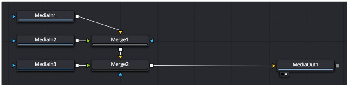
Fusionクリップに変換した3つのクリップで構成されるノードツリー
