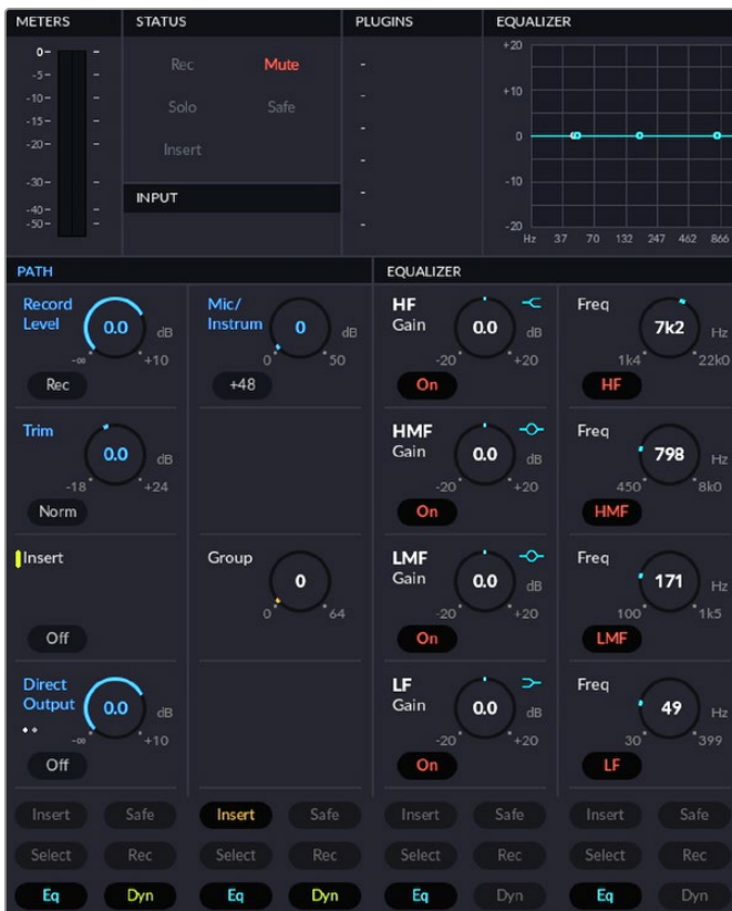
別売のHDMIモニターでパスの視覚的フィードバックを行う入力コントロールセット
