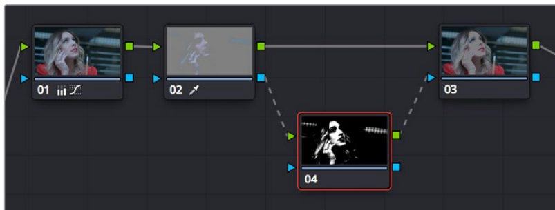
キー出力をRGB入力に接続して2つ目のノードのコントロールでキーを調整
