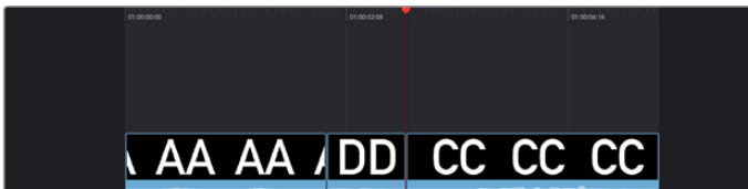
再生ヘッドのクリップ全体 (BB) と後続クリップ (DD) を差し替えるリップル上書き
