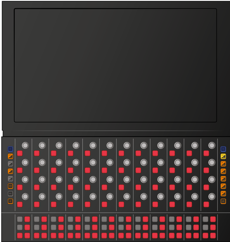
各チャンネルの4つの赤いIn/Outトグルスイッチと4つのダイヤルコントロールを表示するIn-LineEQ表示モード
