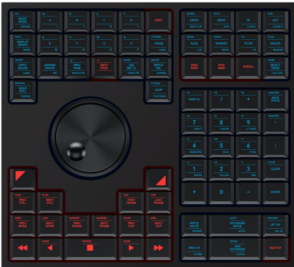
(上) サーダイアルパネルのデフォルトで点灯しているキー。(下) SHIFT DOWNを押すと、SHIFT DOWNの機能を持つすべてのキーがハイライト表示され、どのキーが選択可能かがすぐわかる。
