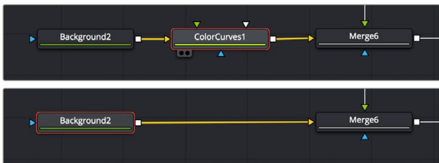
ノードツリーからノードを削除する前 (上)、削除後にアップストリームとダウンストリームのノードが自動的に接続される (下)
