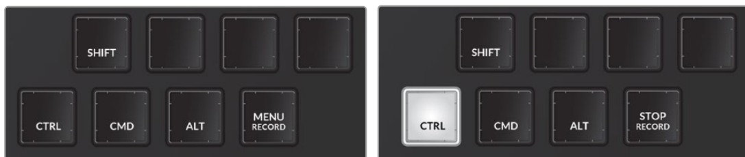
マクロ記録時に「Menu」キーを押すと「Menu Record」になり、マクロ記録時に「Control」キーを押すと「Stop Record」になります。
