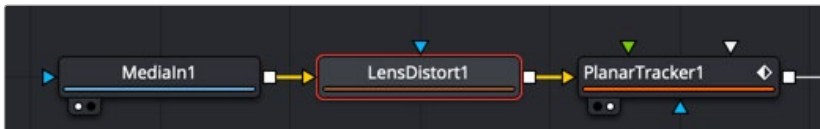
MediaIn1とPlanar Trackerの間に挿入されたLens Distortノードがレンズの歪みを取り除く
