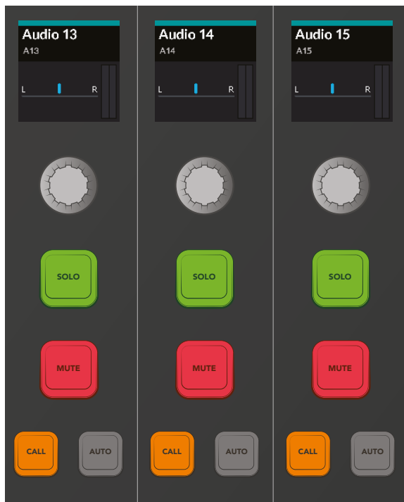
LCDフェーダーチャンネルディスプレイ、「フェーダーパン」ノブ、「フェーダーチャンネル」コントロールボタン。
