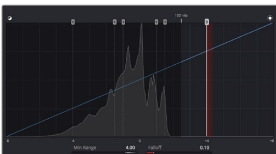
(左) ゾーングラフの元々のゾーンの分布。(右) Specularの「Minレンジ」ハンドルをドラッグして、画像のヒストグラムで最も明るいハイライトを交差させ、Specularコントロールが画像のその部分に影響を与えるようにする。
