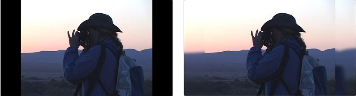
(左) 元のSDイメージ、(右) デフォルトの「ブランキングフィル」適用後
