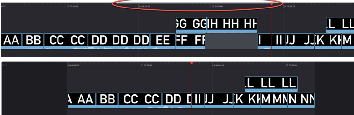
(上) 削除する部分にタイムラインでイン点とアウト点をマーク、(下) イン点とアウト点の間の部分が削除され、右側のクリップがすべて左に移動
