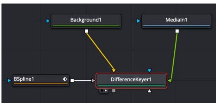
背景上の被写体と背景のみの被写体の2つの入力を持つDifference Keyer
