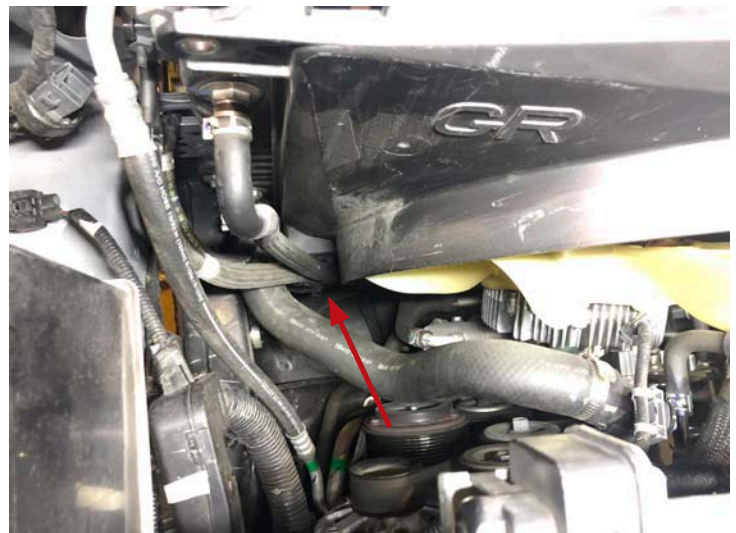
Unhook Cooler Lines
