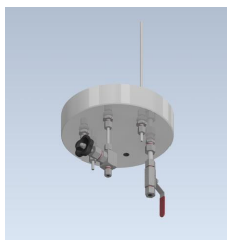
Obrázek 63: Spodní víko reaktoru – 3D model – pohled 2
