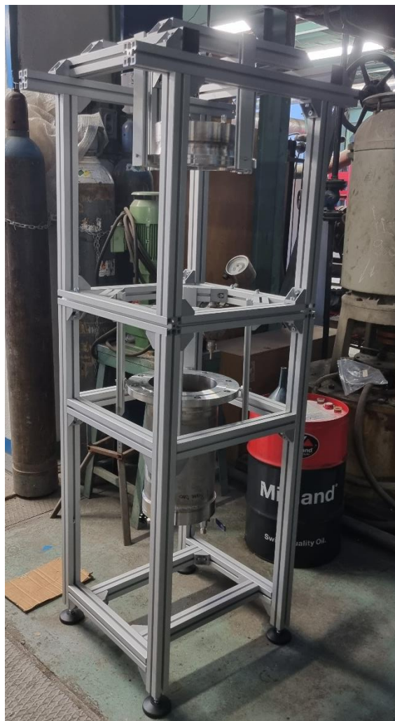
Obrázek 84: Základový rám se zavěšeným reaktorem v otevřeném stavu
