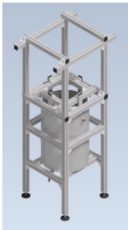
Obrázek 86: Sestava chladicí nádrže v sestavě měřicí trati – 3D model
