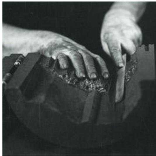
(79) Tapio Wirkkala travaille le graphite pour former le moule d'un futur objet en verre ; la main, l'outil et la matière sont liés par le touché, par un contact physique et presque sensuel
