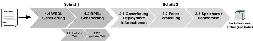
Abbildung 8.7.: Schematischer Aufbau des Generierungsalgorithmus für BPEL
