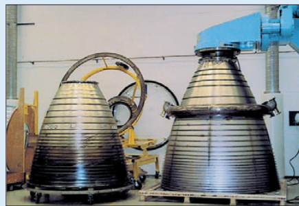
Сопловые насадки двигателей Vulcain и Vulcain-2
