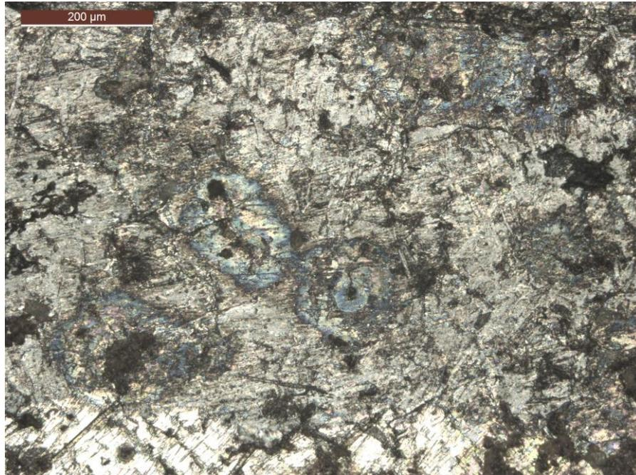
**Figura 4.12.** Superfície da pista de desgaste com material removido.
