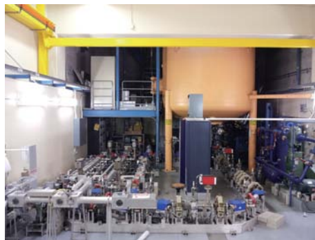
The Free Electron Laser at UCSB, the source of the THz light used in the experiments (photo by Ben Zaks) 加州大學聖芭芭拉分校的自由電子激光器 提供實驗所需的太赫茲光
