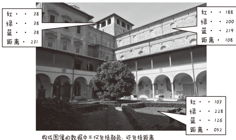
图 4.3 用 RGB-D 传感器获取的图像中，每个像素都含有距离信息
