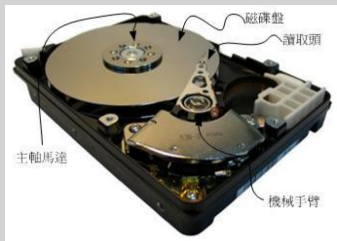
图 2.4.1、硬盘物理构造(图片取自维基百科)
