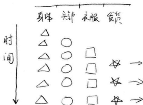
图 5.11 使用流水线生产玩偶
