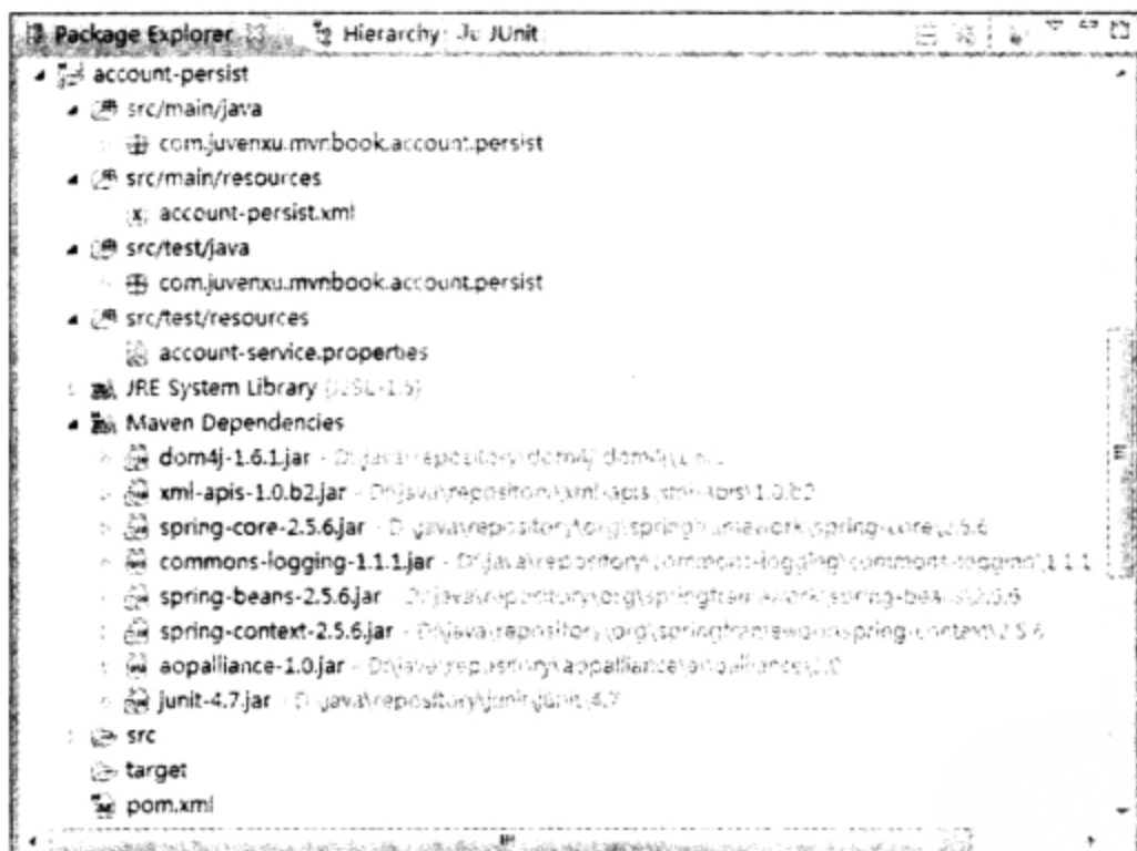
图 16-8 m2eclipse 中的 Maven 项目的结构
