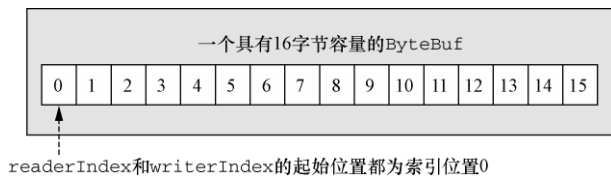
图 5-1 一个读索引和写索引都设置为 0 的 16 字节 ByteBuf
