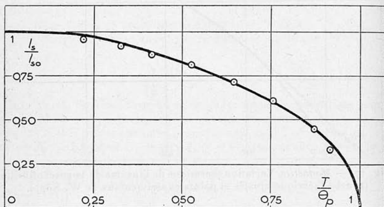
Fig. 18. — Magnétite . Variation thermique de l'aimantation spontanée (courbe calculée d'après les données paramagnétiques et points expérimentaux de P. Weiss).
