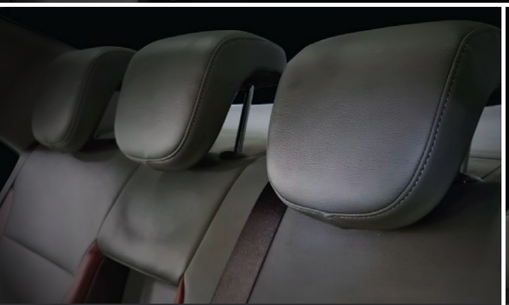
Tựa đầu tại vị trí trung tâm, điều chỉnh được độ cao
