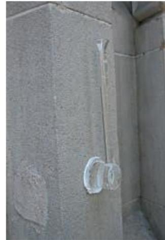
Fig. 53. Ensayo de pipeta. Extraído de *Proyecto Coremans (2013)*
