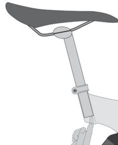
**NOTA:** Algunas bicicletas tienen un orificio para la vista en el tubo del asiento, cuyo propósito es facilitar la observación de si la caña del sillín está insertada en el tubo del asiento lo suficiente como para que sea segura. Si su bicicleta tiene una mirilla, utilícela en lugar de la marca "Inserción mínima" o "Extensión máxima" para asegurarse de que la caña del sillín esté insertada en el tubo del asiento lo suficiente para que se pueda ver a través del orificio.
