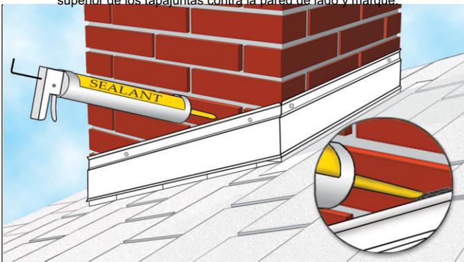
**13** Marque la tapajunta contra la pared de la parte posterior incluso a lo largo de las esquinas de la chimenea y las coloque a lo largo de su marca. Revise las partes superiores de las cuatro (4) tapajuntas contra la pared para asegurarse que cada esquina tiene una muesca "V". Calafatee las cuatro tapajuntas contra la pared a lo largo de la "V" y en las esquinas. Asegúrese de que no hay ningún hueco, burbuja, ni bolsa de aire para las fugas de agua.
