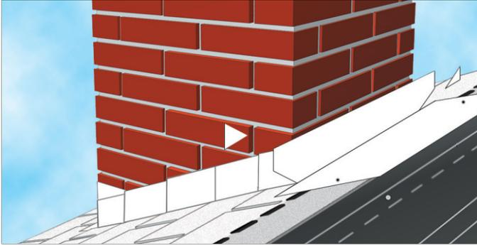
**9** Centre la tapajunta de cricket a lo largo de la parte posterior de la chimenea extendiendo tres (3) o cuatro (4) pulgadas más allá de ambos extremos de la chimenea. Haga una muesca en ambos extremos con su respectiva esquina y envuelva las lengüetas en los lados. Clave en su lugar.
