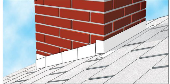
**10** Complete la instalación de las tejas. Compruebe su trabajo bien y asegúrese que no ningún hueco ni abertura en donde el hielo y el agua pueden escaparse.
