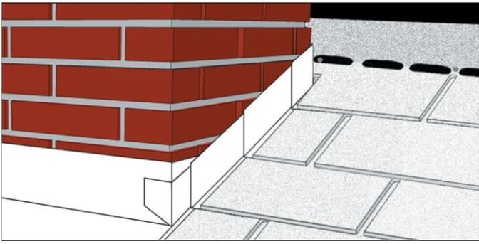
**7** Corte la teja para encajar alrededor de la parte posterior de la chimenea (el corte puede ser ceñido con poco o ningún espacio).
