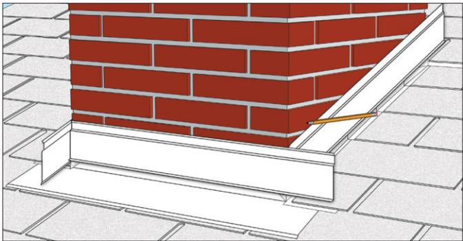
**11** Instale las tapajuntas contra la pared con las partes superiores alineados alrededor de la chimenea. A partir de los lados, marque a lo largo de las partes superiores de las tapajuntas contra la pared dejando un pequeño espacio entre las tejas y la parte inferior de la tapajunta contra la pared para el drenaje. Alinee la parte superior de la parte delantera y trasera de las tapajuntas contra la pared con la parte superior de los tapajuntas contra la pared de lado y marque.
