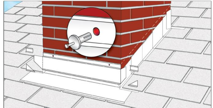
**12** Corte los extremos de las tapajuntas contra la pared como se muestra y dóblelas en la esquina de la chimenea. Para evitar que el metal deforme, corte las esquinas superiores en las esquinas de la chimenea y a continuación doble las lengüetas alrededor de los lados. Instale los sujetadores de mampostería por la tapajunta contra la pared en ta ladrillo. Asegúrese de que el metal cabe cómodamente contra el ladrillo.
