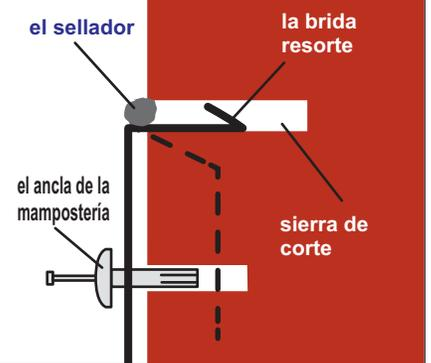
**R** Usando una hoja de sierra estándar de mampostería, inicie en la parte delantera de la chimenea a una profundidad de 1 1/4 in. Inserte la tapajunta contra la pared como se muestra aquí recordando que la brida resorte comprimirá. Recorte los lados y doble hacia atrás. Instale el ancla de la mampostería (usualmente 2 a 3). Termine la pieza de sellado con una gota de sellador.
