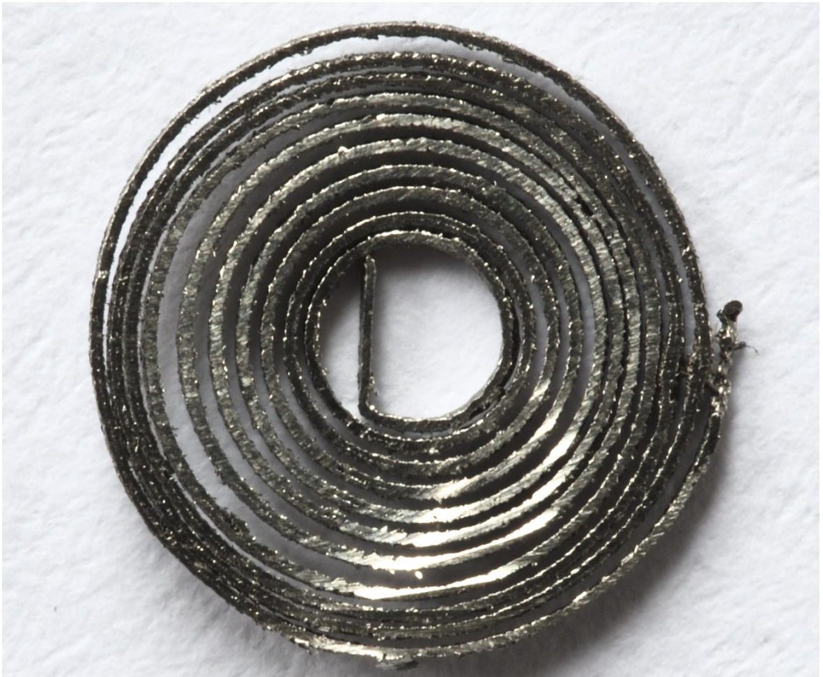
Abbildung 37: Fotografie einer mittels Mikro-SLM hergestellten Feder
