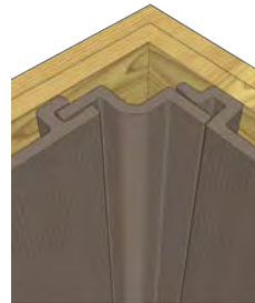
FINEO auf einspringender Ecke
