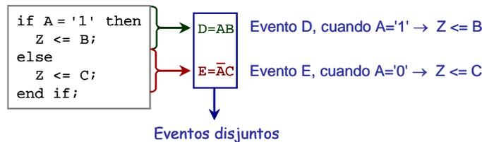
Figura 3-14: Generación de nodos disjuntos en una sentencia condicional (multiplexor)
