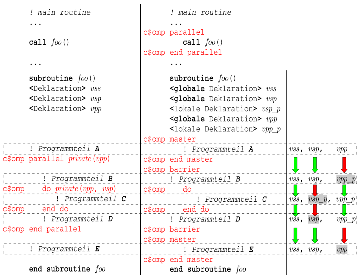
Abbildung 18: Links: Programmcode im Ausgangszustand; Mitte: Mit den Richtlinien 4.1 konformer nachbearbeiteter Programmcode; Rechts: Variablenübergänge zwischen den einzelnen Programmteilen.
