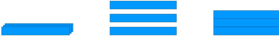
Abbildung 55: Datenstruktur-Varianten für die Berechnung mehrerer stochastischer Versuche. Links: Mehrfachnutzung zu unterschiedlichen Zeitpunkten; Mitte: jeweils einzelne Datenobjekte; Rechts: höher-dimensionales Datenobjekt.
