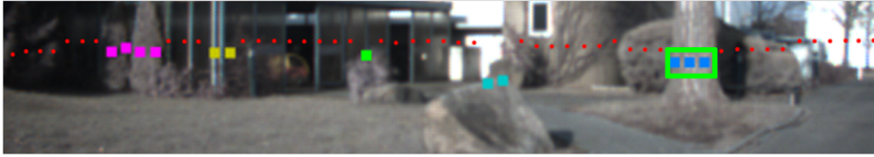
Abbildung 4.2: Ein in das Kamerabild referenzierter Scan des 2D-LiDARs (farbige Punkte). Größer hervorgehobene Punkte zeigen mögliche Landmarkenkandidaten nach dem ersten Detektionsschritt. Das grüne Rechteck bezeichnet eine nach dem zweiten Schritt verifizierte Landmarke und den Ausschnitt, welcher zur Berechnung der visuellen Signatur verwendet wird [Ulr10].
