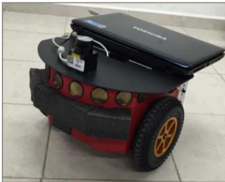
Fig. 7. Montaje y conexión del robot Pioneer 3-DX.
