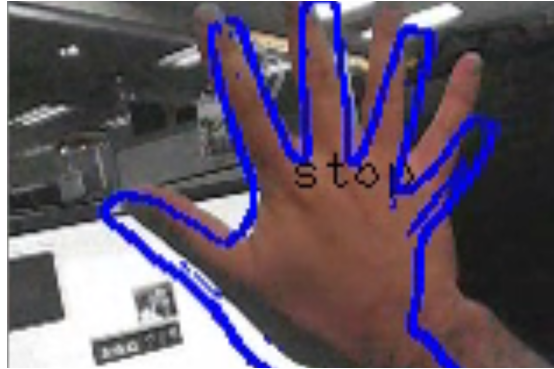
Fig. 4. Gesto de la palma abierta utilizado por el algoritmo de desbloqueo para activar el sistema, presentando un patrón de gestos como realidad aumentada para dar al usuario una indicación del uso.
