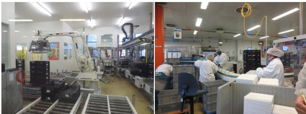
Figs. 31 e 32 – Carregamento da água pelo robot e verificação dos tabuleiros por pessoas na KCS.
