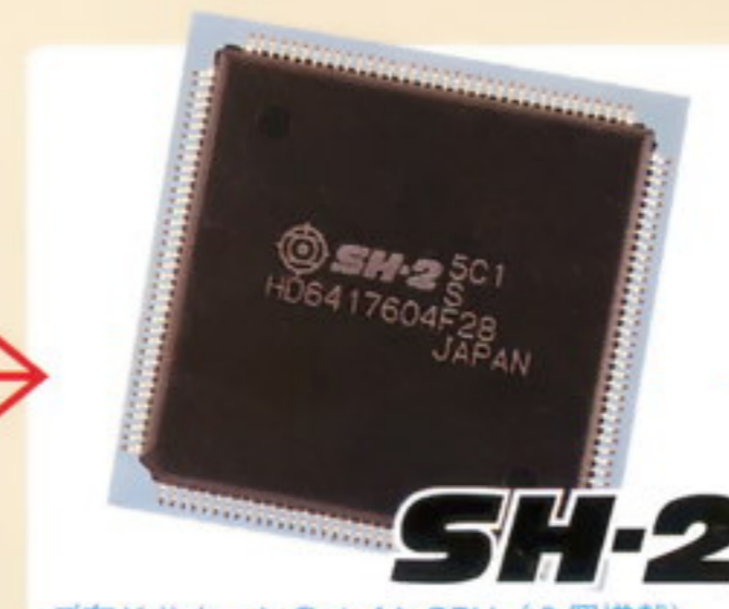
ご存じサターンのメインCPU(2個搭載)。積和演算用のDSPなどを内蔵。約30MIPS。
