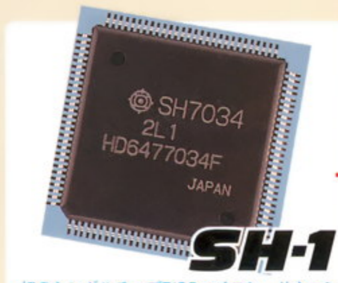
初のシングルチップRISCマイコン。サターンにもCD制御用として搭載された。約20MIPS。
