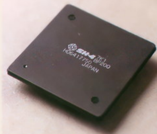
1.5Wという低消費電力を実現したSH-4。放熱の小ささという点でメリットは大きい。
