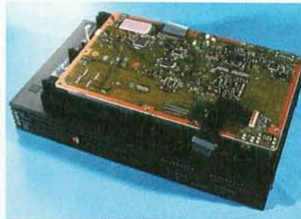
■ Und da steckt sie auch schon, die sagenumwobene Hauptplatine der PS2. Bevor ihr jedoch an die Chips gelangt, müsst ihr das Board umdrehen und ein fragiles Breitbandkabel lösen.
