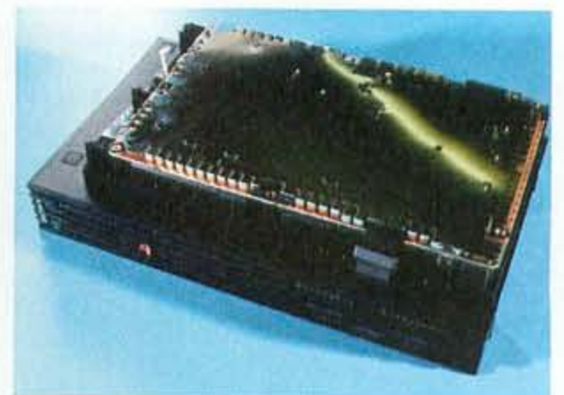
■ Zunächst erwartet euch dieses Wärme-Ableiter-Blech, das zusammen mit dem leistungsstarken, aber zum Glück relativ leisen Lüfter eine Überhitzung der empfindlichen Hauptplatine verhindern soll.
