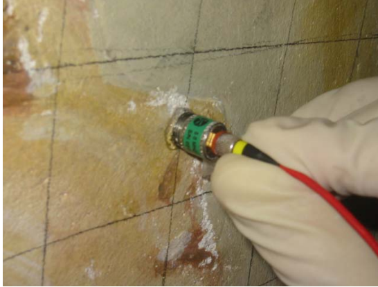
Figura 114. Detalle del transductor de 5MHz
