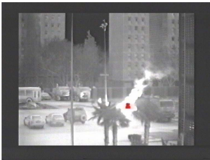
Figura 44. Imagen IR. Detección de fuego controlado en Parque de Bomberos.
