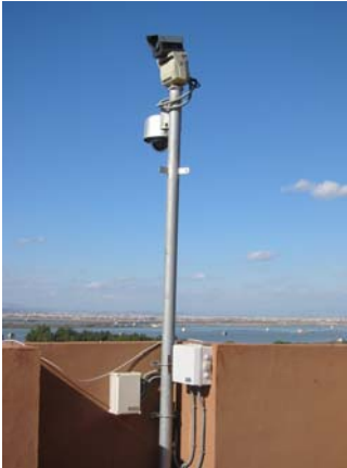
Figura 41. Ejemplo de instalación en una estación local móvil y detalle de cámara termográfica Flir Thermovision 320V.
