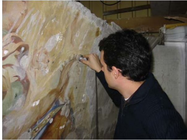
Figura 129. Fotografía de la realización de una medida ultrasónica sobre el modelo a escala
