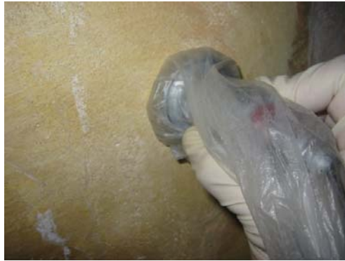
Figura 116. Transductor cubierto por plástico durante la medida
