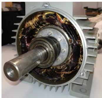
Figura 15. Fallo en el sistema de aislamiento
