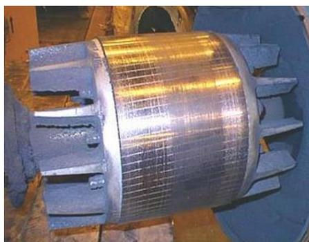
Figura 11. Rozamiento del rotor con el estator debido a excentricidades [8]
