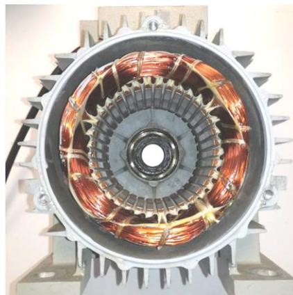
Figura 2. Estator de un motor de inducción con sus respectivos devanados
