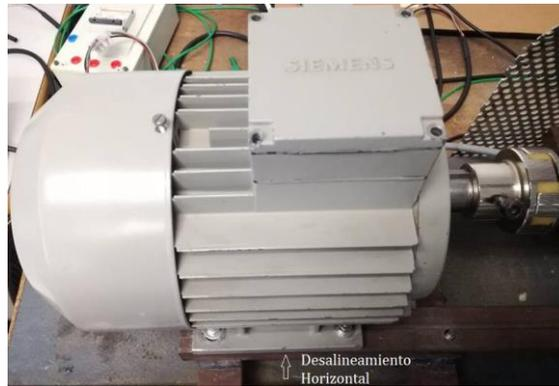
Figura 25. Desalineamiento horizontal del motor
