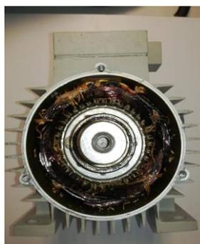
Figura 30. Fallo en el sistema de aislamiento por sobrecalentamiento
