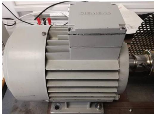
Figura 27. Excentricidad debido a incorrecta sujeción de la base del motor
