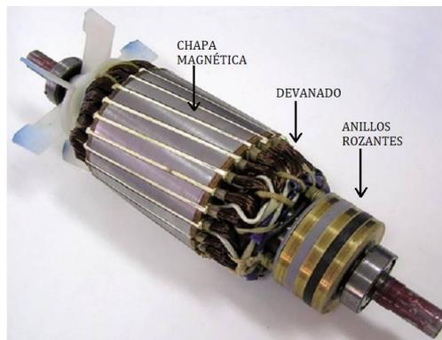
Figura 3. Rotor bobinado. [2]
