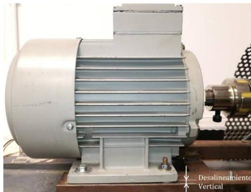
Figura 26. Desalineamiento vertical del motor
