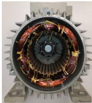
Figura 29. Fallo en el sistema de aislamiento en 2 fases
