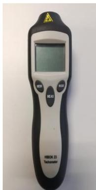
Figura 19. Tacómetro digital HIBOK 23
